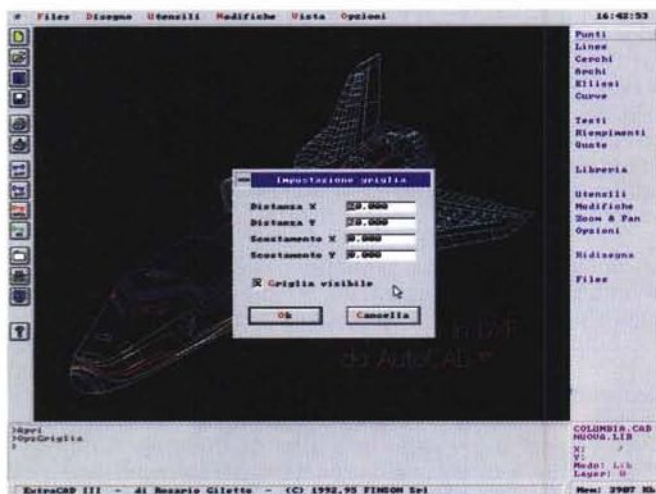
Due momenti nell'impiego del programma, la definizione dei parametri relativi alla griglia ed il disegno di un elemento della libreria.
